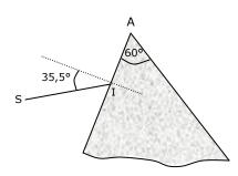
Un prisme d'angle au sommet A = 60° est taillé dans un verre d'indice n = 1.4. On fait tomber un rayon lumineux monochromatique sous une incidence de 35,5° comme l'indique la figure ci-contre.
