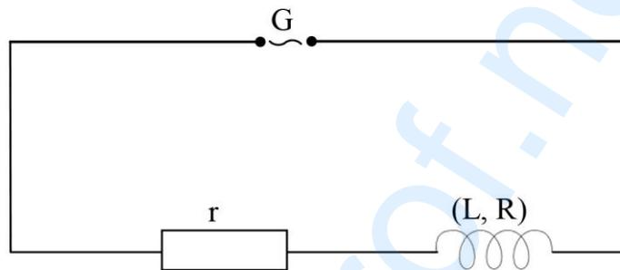
On désire étudier à l'oscillographe bicourbe ce circuit en visualisant la tension  $u(t)$  fournie par  $G$  sur la voie  $Y_A$  et l'intensité  $i(t)$  du courant dans le circuit sur la voie  $Y_B$ .
