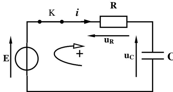
$$E - u_R(t) - u_C(t) = 0 ; \text{ avec } u_R(t) = R i(t) = RC \frac{du_C(t)}{dt}$$
