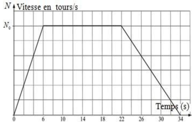
$N_0$  : Vitesse de fonctionnement normal du moteur : pendant le fonctionnement normal, l'arbre du moteur muni d'une petite tache, donne une seule tache apparemment immobile en éclairage stroboscopique pour les fréquences **10Hz**, **15Hz** et **30Hz** ; et autres observations pour les fréquences plus élevées.
